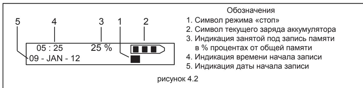
После выбора кнопками «△» и «▽» записи для прослушивания нажать на кнопку «□» – начнется воспроизведение выбранной записи и на дисплее отобразится информация о воспроизводимой записи (см рис.4.3)
