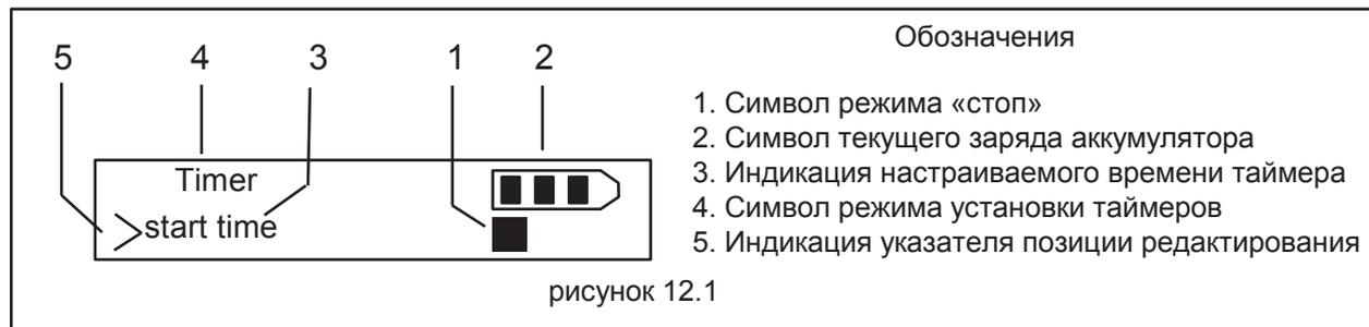
Кнопками «  $\Delta$  » и «  $\nabla$  » выберите для установки «start time» - начальная точка или «stop time» – конечная точка, нажмите кнопку «  $\square$  ». На дисплее появится индикация установки даты работы таймера(см рис.12.2)
