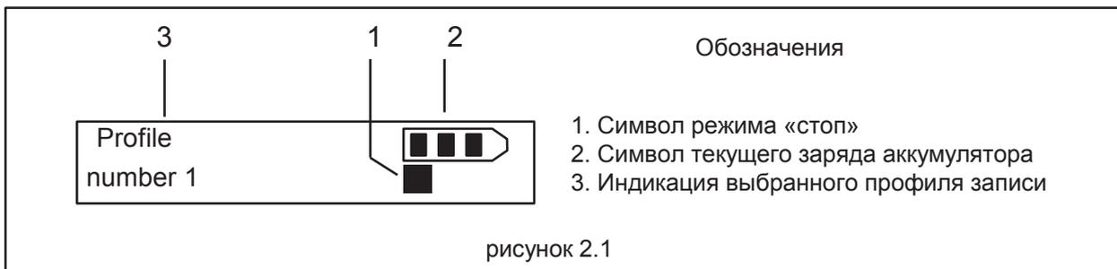
Кнопками  $\triangle$  и  $\nabla$  выбрать нужный профиль записи. Профиль записи можно задать самостоятельно (см «Настройки профилей записи» или воспользоваться заводскими установками). После нажатия кнопки  $\square$  будет установлен выбранный профиль записи и появится надпись «Profile set OK». Для перехода в ждущий режим нажмите одновременно кнопки  $\triangle$  и  $\nabla$ .
