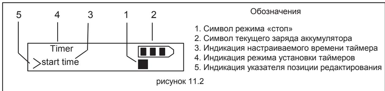
Кнопками «  $\Delta$  » и «  $\nabla$  » выберите для установки «start time» - начальная точка или «stop time» – конечная точка, нажмите кнопку «  $\square$  ». На дисплее появится индикация установки времени и даты работы таймера.
